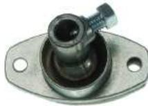
Un raccord économique, moulé sous pression en alliage de zinc, fixe fermement la tige de commande au support de volet à organe unique mobile, passant au travers du conduit. Il est livré entièrement assemblé avec une vis pression, un joint d'étanchéité de renfort en néoprène et une rondelle cuvette en nylon qui maintient la rotule fermement contre le conduit et élimine les bruits.
